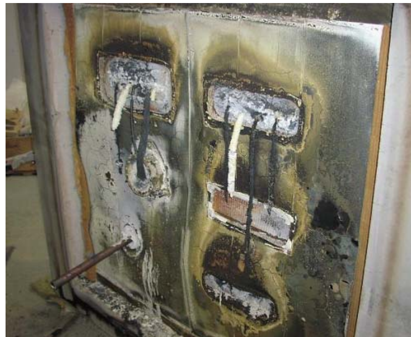
Polttouunin sisäpuoli 90min. palon jälkeen
