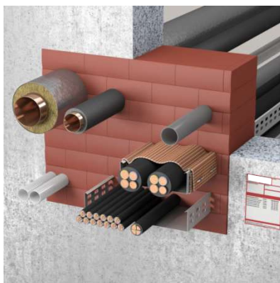
Kuva 16. Esimerkki palokatkoitiilien käytöstä tilapäisenä tai pysyvinä palokatkona.
