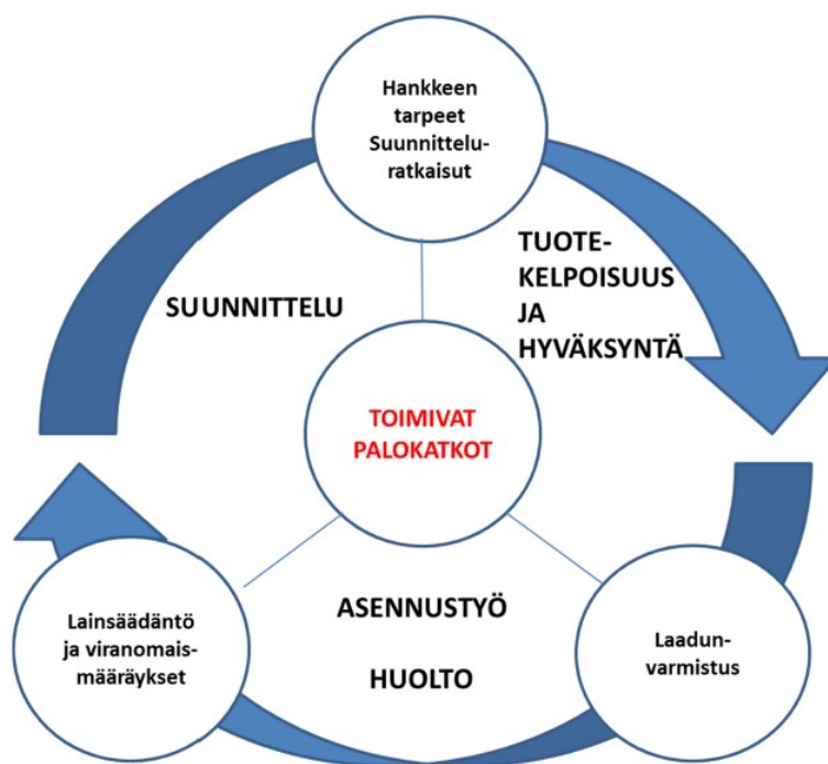
Kuva 2. Toimiva palokatko syntyy osapuolten välisellä yhteistyöllä (RIL 270-2018).
