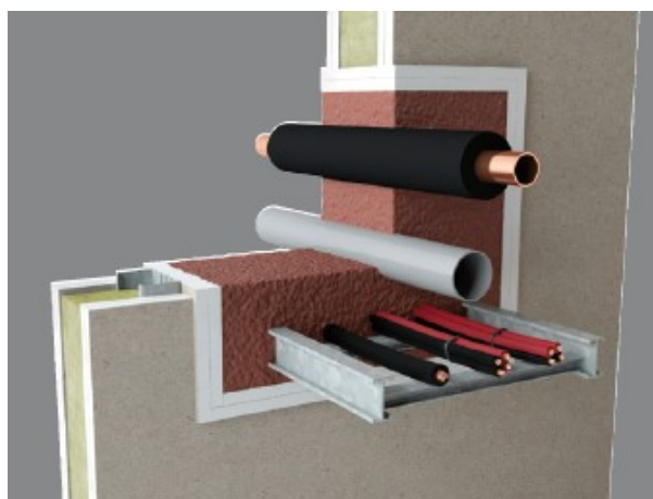
Kuva 9. Esimerkki 2- komponenttisen palokatkovaahtojen käytöstä yhdistelmäpalokatkokossa.
