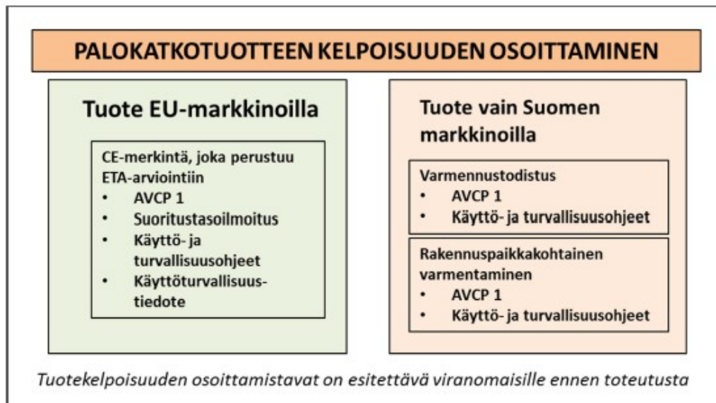
Kuva 19. Palokatkojen tuotekelpoisuuden hyväksyntämenettelyt. (RIL 270-2018).
